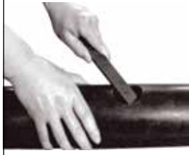
2. Çapakları temizleyin Remove burrs
